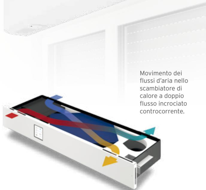
Movimento dei flussi d'aria nello scambiatore di calore a doppio flusso incrociato controcorrente.
