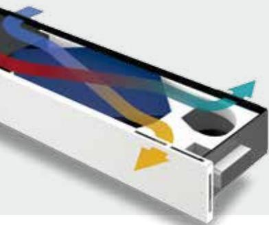
Movimento dei flussi d'aria nello scambiatore di calore a doppio flusso incrociato controcorrente.
