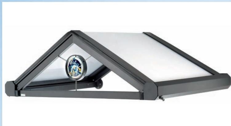
È una pensilina tradizionale dalla forma piramidale che si distingue per il decoro frontale che può essere a rosone, a raggiera e classico. Viene fornita, pre-assemblata, completa di grondine laterali e mensole di sostegno. Sono realizzate con struttura ed accessori in **alluminio lega 6060 T5** termolaccato e copertura in lastre monolitiche di polimetilmetacrilato o policarbonato protette ai raggi ultravioletti
