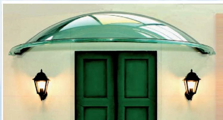
La pensilina autoportante GLORIA è realizzata per termoformatura di lastre compatte di Polimetilmetacrilato (PMMA) originale di sintesi esenti di monometri di recupero, nella forma a quarto di sfera ribassata con incorporati scarichi laterali per le acque piovane. Sono fornite in comodi Kit di montaggio particolarmente studiati per il fai da te.
