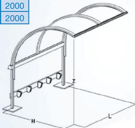
La pensilina BORGIO viene realizzata con struttura portante in alluminio e rinforzi in acciaio zincati a caldo e successivamente verniciati con lo stesso trattamento utilizzato nella verniciatura delle parti in alluminio. La pensilina è costituita da una copertura a settore circolare ottenuta mediante curvatura di profili estrusi di **alluminio lega 6060 T5** protetti dagli agenti atmosferici mediante trattamento di verniciatura a polveri termoindurenti.
