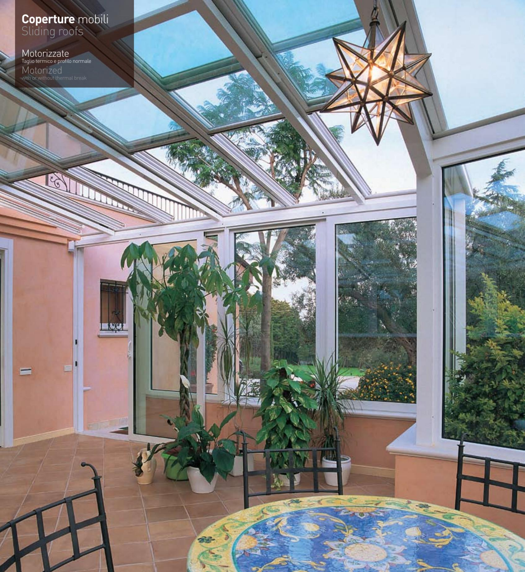
Il sistema è composto da una struttura modulare in profilati di alluminio di grandi sezioni quali travi, ancoraggi a muro, canale di gronda e colonne di sostegno. Il movimento avviene grazie ad una tecnologia che garantisce la massima precisione. Il sistema è disponibile sia in profilo normale sia a taglio termico, con isolamento ottenuto per mezzo di interposizione di materiale isolante tra i vari profilati.
