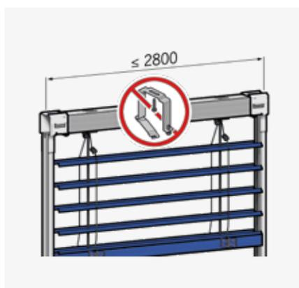
La costruzione autoportante della tenda non danneggia l'isolamento nella veletta e riduce i costi di manutenzione. Fino a una larghezza di 2800 mm, il sistema viene fornito senza fissaggio per il cassonetto superiore: l'isolamento rimane intatto e viene ridotta la trasmissione acustica.
